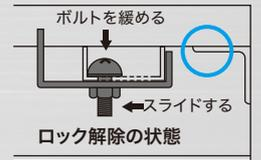
軸径φ5のプラスドライバーをご使用下さい。
